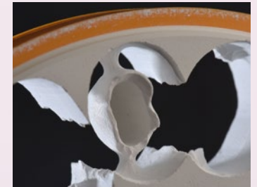
Skadad ersättning tas ut från fräsen.
