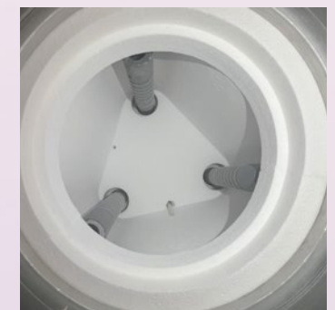
Värmeelement av molybdendisilicid (se ovan) och kiselkarbid (se nedan). Värmeelementen av kiselkarbid åldras inte och är därför att föredra.
