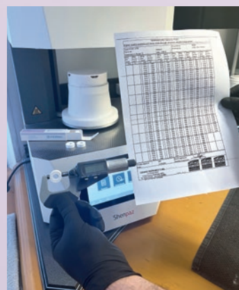
Kalibrering av ugn med hjälp av PTC-ring, ett digitalt skjutmått och temperaturtabell.
