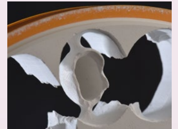
Skadet restaurering ved fjerning fra fresemaskinen.
