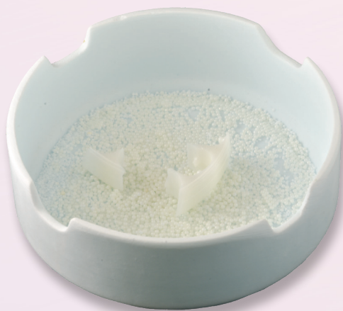
Zbytky nezbarveného vysoce translucentního zirkonu uloženého v sintrovací misce na sintrovacích kuličkách pro dekontaminaci pece.
