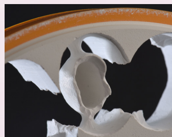
Poškozená náhrada při vyjmutí z frézky.
