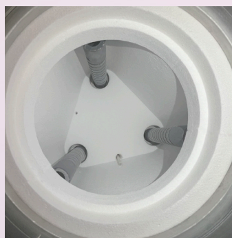
Topná tělesa z disilicidu molybdenu (nahore) a karbidu křemíku (dole). Topná tělesa z karbidu křemíku jsou odolná proti stárnutí, a proto jsou vhodnější.
