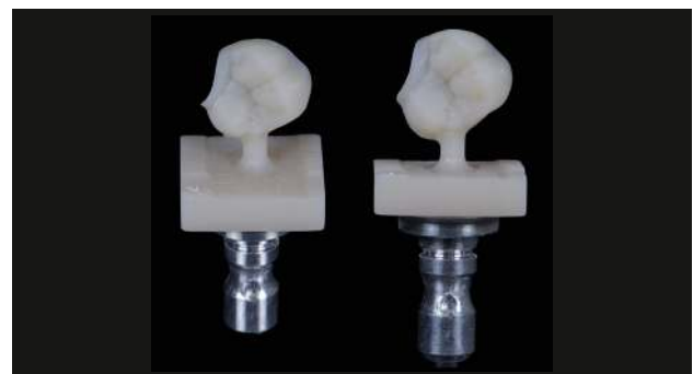
Abb. 24. Gefrästes Onlay aus KATANA™ AVENCIA™ ML mit glatten Rändern und natürlicher Oberflächentextur
