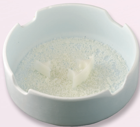
Bucăți reziduale de zirconiu, fără nuanță, translucidență crescută, plasate într-un creuzet de sinterizare pe perle de sinterizare pentru decontaminarea cuptorului.
