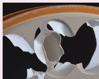
Restaurare deteriorată la îndepărtarea din mașina de frezat.
