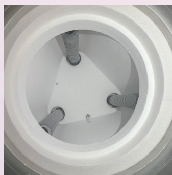
Elementele de încălzire din disilicat de molibden și carbură de siliciu. Elementele de încălzire din carbură de siliciu sunt rezistente la îmbătrânire și, prin urmare, sunt de preferat.
