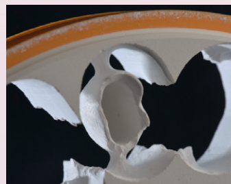
Uszkodzona podbudowa po wyjęciu z frezarki.
