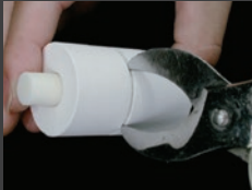
Séparation avec une pince à plâtre
