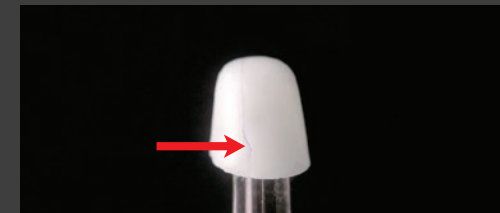
Fêlure produite durant le polissage
