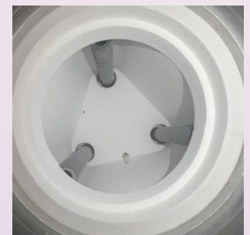
Éléments chauffants en disilicide de molybdène (en haut) et en carbure de silicium (ci-dessous). Les éléments chauffants en carbure de silicium sont résistants au vieillissement et sont donc préférables.
