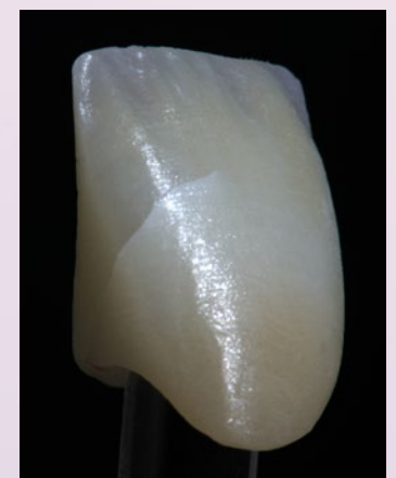
Couronne antérieure avec une microcoupure et une fissure qui pourrait avoir été induite pendant le fraisage.
