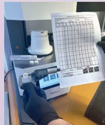
Étalonnage du four à l'aide d'un anneau PTC, d'un pied à coulisse numérique et d'une table de température.
