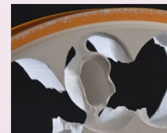
Restauration endommagée lors du retrait de la fraiseuse.
