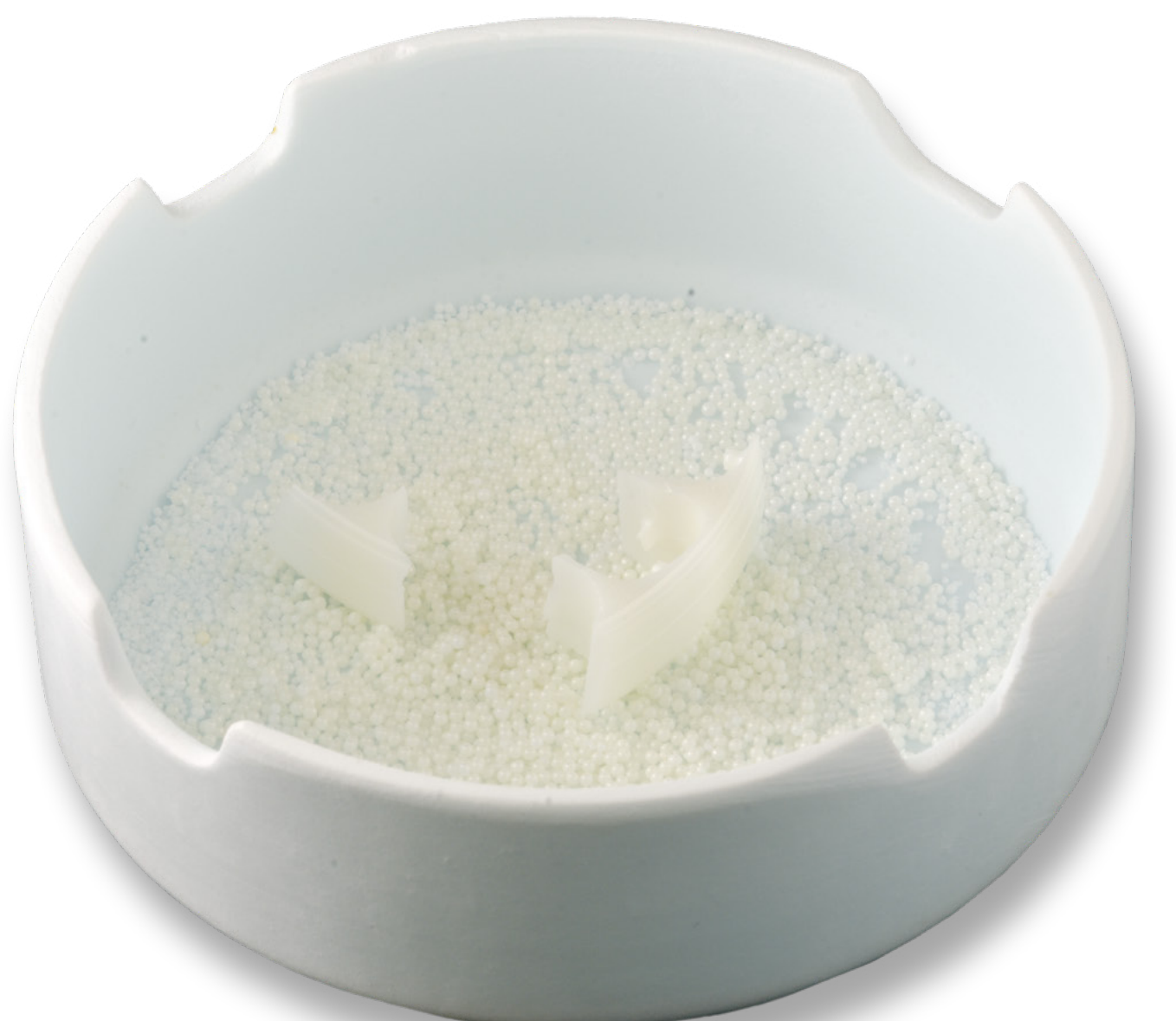
Ofendekontamination: Reste von nicht eingefärbtem, hochtransluzentem Zirkonoxid in einer Sinterschale auf Sinterperlen platziert.
