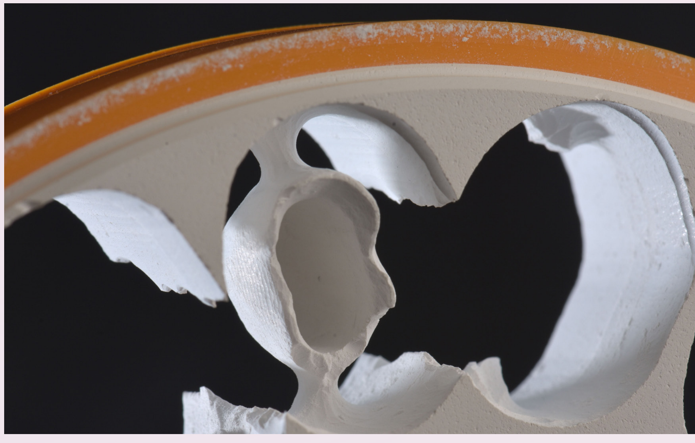
Beschädigte Restauration bei Entnahme aus dem Fräsgerät.
