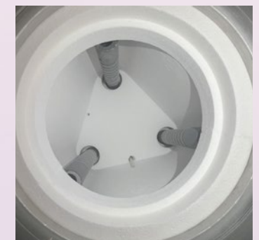
Éléments chauffants en disiliciure de molybdène (en haut) et en carbure de silicium (ci-dessous). Les éléments chauffants en carbure de silicium sont résistants au vieillissement et sont donc préférables.
