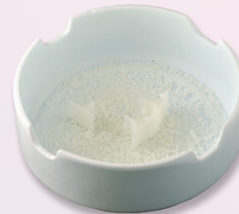
Chutes de disque de zirconie à haute transparence non teintées placées dans un plateau de frittage sur les billes de frittage pour la décontamination du four.
