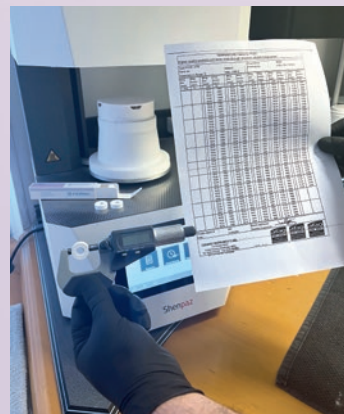
Étalonnage du four à l'aide d'un anneau PTC, d'un pied à coulisse numérique et d'une table de température.
