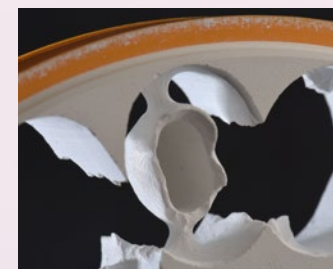
Restauration endommagée lors du retrait de la fraiseuse.
