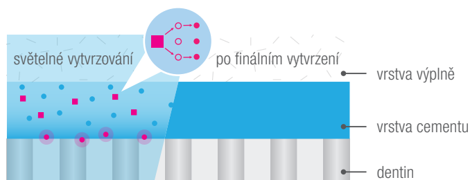
Obr. 2: Zrychlení světelného vytvrzení pomocí radikálových zesilovačů.
