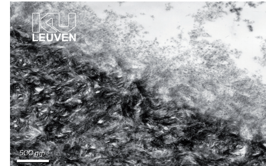
Das Transmissionselektronenmikroskop zeigt die Verbindung von CLEARFIL™ SE BOND.
