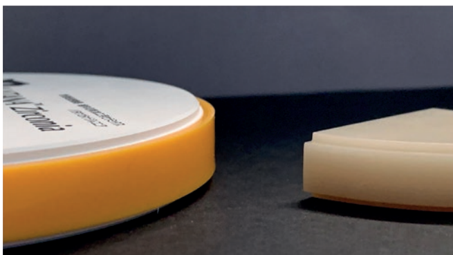
KATANA™ Multilayer HTML før (venstre) og efter sintring.
