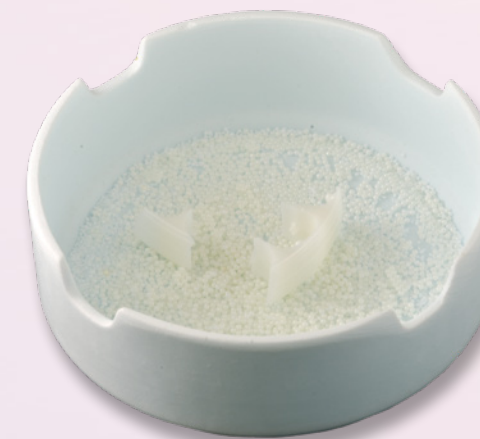
Chutes de disque de zircone à haute translucidité non teinté placées dans un plateau de frittage sur les billes de frittage pour la décontamination du four.
