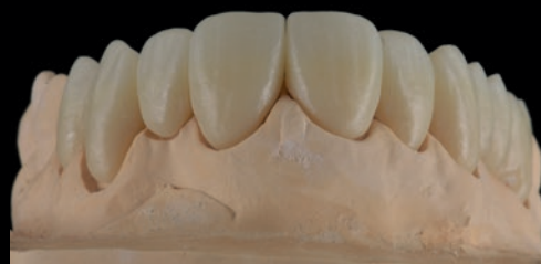
Figur 1: 4- och 6-ledsbroar av KATANA™ Zirconia YML efter fräsning och sintring. En naturlig vestibulär ytstruktur spelar en väsentlig roll vid skapandet av estetiska monolitiska restaurationer.
