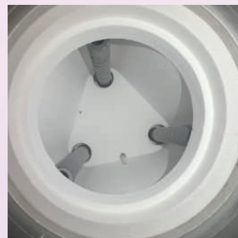
Heizelemente aus Molybdändisilizid (oben) und Siliziumkarbid (unten). Heizelemente aus Siliziumkarbid sind alterungsbeständig und daher zu bevorzugen.
