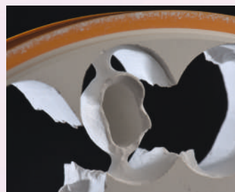
Beschädigte Restauration bei Entnahme aus dem Fräsgesät.
