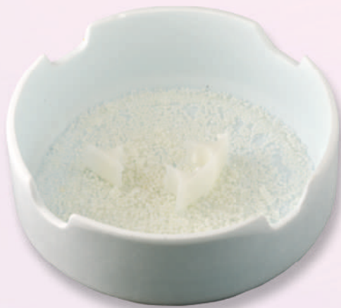
Ofendekontamination: Reste von nicht eingefärbtem, hochtransluzentem Zirkonoxid in einer Sinterschale auf Sinterperlen platziert.
