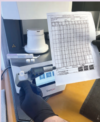
Ofenkalibrierung mit PTC-Ring, digitalem Messschieber und Temperaturtabelle.
