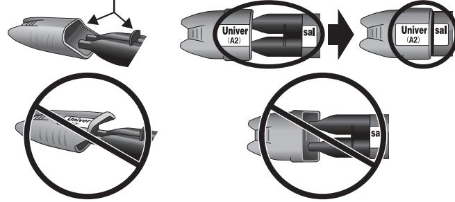
Indien de dop verkeerd om teruggedraaid wordt, kan Paste A in contact komen met Paste B aan het uiteinde van de sput. Wanneer de heterogene pasta's met elkaar in contact komen, zal het gedeelte van de pasta's die met elkaar in contact zijn, uitharden.
