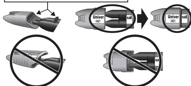
Pokud uzávěr není nasazen ve správném směru, může pasta „Paste A“ přijít na hrotu do kontaktu s pastou „Paste B“. Při vzájemném kontaktu heterogenních past kontaktní oblast zatvrdne.
