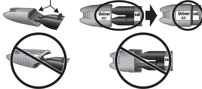
Se a tampa for colocada ao contrário, a Paste A poderá entrar em contacto com a Paste B na ponta da seringa. Se as pastas heterogéneas entrarem em contacto uma com a outra, a porção das pastas que estiverem em contacto sofrerá polimerização.
