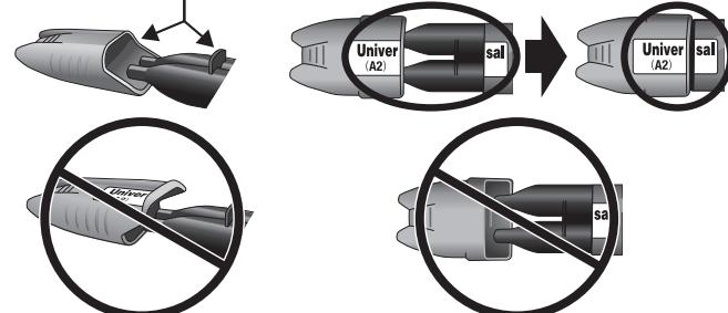
Si le capuchon n'est pas remis dans le bon sens, Paste A risque d'être en contact avec Paste B au niveau de l'embout de la seringue. Lorsque les pâtes hétérogènes entrent en contact, les parties qui sont entrées en contact se polymérisent.
