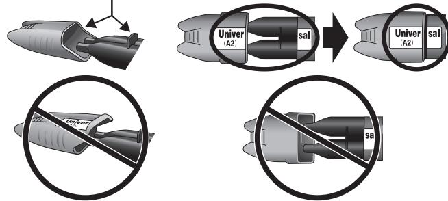
Om hättans riktning är fel, kan Paste A komma i kontakt med Paste B på sprutans spets. När de heterogena pastorna kommer i kontakt med varandra, ska den delen av pastan som är i kontakt härdas.
