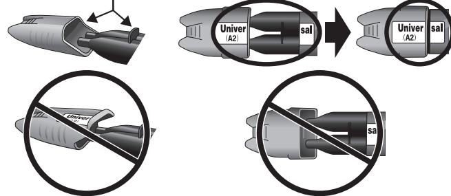
Wurde die Verschlusskappe nicht in korrekter Richtung aufgesetzt, kann Paste A an der Austrittsöffnung der Spritze mit Paste B in Kontakt kommen. Bei Kontakt der heterogenen Pasten härtet der Kontaktbereich aus.
