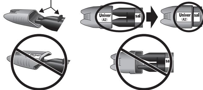
Dacă direcția de repunere a capacului este incorrectă, este posibil ca Paste A să vină în contact cu Paste B la vârful seringii. Când paste heterogene vin în contact una cu cealaltă, porțiunea de contact a pastelor va polimeriza.
