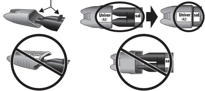
Se la direzione di ricollocazione del tappo è errata, la Paste A potrebbe entrare in contatto con la Paste B sulla punta della siringa. Quando paste eterogenee vengono a contatto tra loro, la parte interessata delle paste potrebbe polimerizzarsi.
