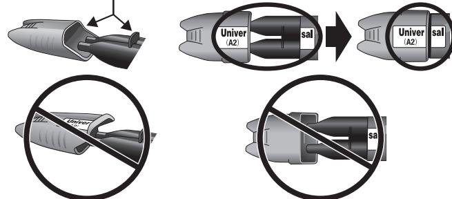
Si la dirección de colocación del tapón es incorrecta, la Paste A podría entrar en contacto con la Paste B en la punta de la jeringa. Cuando pastas heterogéneas entran en contacto entre sí, la zona del contacto de las pastas curará fráguará.
