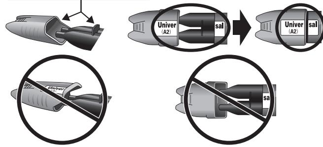
Ako je smjer stavljenog poklopca neispravan, Paste A može doći u dodir s Paste B na vrhu štrcaljke. Kada heterogene paste dođu u dodir, stvrdnut će se dio pasti u kontaktu.
